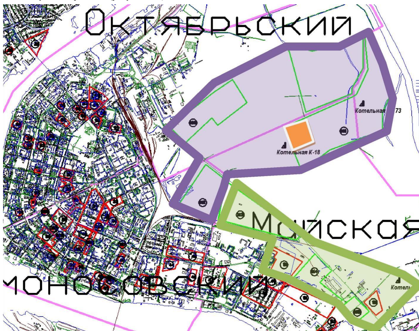
Рисунок 3.2 - Зоны действия предлагаемых к строительству котельных
